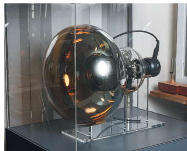
スーパーカミオカンデに実際に使われている光電子増倍管。これがカミオカンデの側面と底面に満遍なく敷き詰められ、光を検出するとそれを電気信号の形で出力する。
